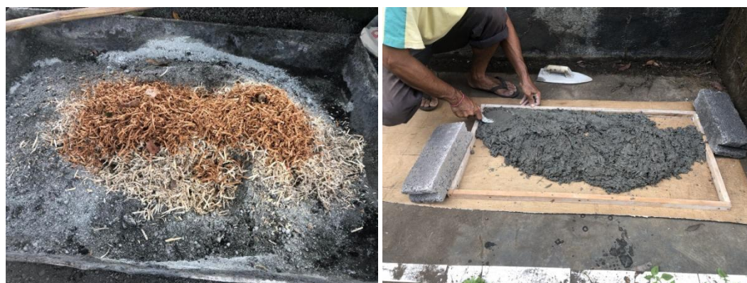
a. Mix 1 cement : 2 sand : 3 sawdust
