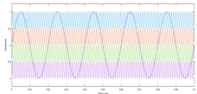
Fig. 3. Sinusoidal PWM
