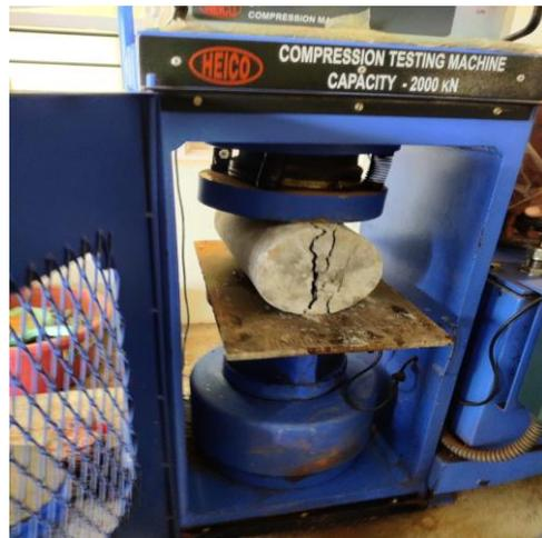
Fig.5 Tensile test
