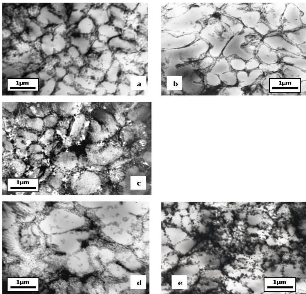
**Fig. 1** Microstructure of ribbon samples (TEM): a ) Al-11%Si-0,055%Sb, b) Al-11%Si-0,11%Sb, c) Al-11%Si-0,22%Sb, d) Al-11%Si-0,022%Sr, e) Al-11%Si-0,051%Sr.
